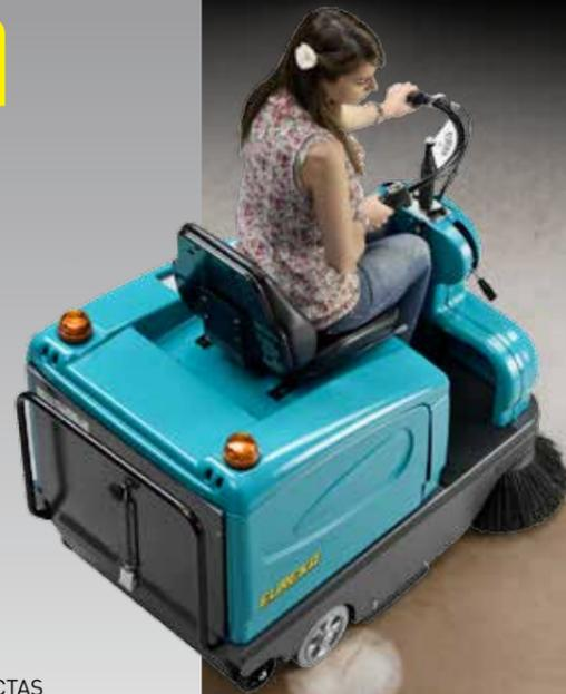
LAS MEDIDAS COMPACTAS DE LA MÁQUINA Y SU PEQUEÑO RADIO DE GIRO (950 MM) LE PERMITE LIMPIAR PERFECTAMENTE EN SUPERFICIES ESTRECHAS, QUE NO SON ACCESSIBLES POR LAS MÁQUINAS GRANDES.
