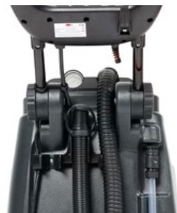
Manguera de desagüe para facilitar el vaciado
